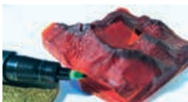
Sehr hohe Auflösung und Präzision: Die Hot Lithography schafft alle möglichen Arten von Oberflächeneffekten (optisch, physikalisch). Gleichzeitig kann die Haptik oder Rauigkeit eines Bauteils individuell angepasst werden.
