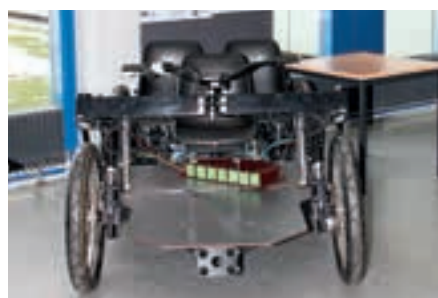
Am LITEC im Zuge einer DA entwickelte Rikscha mit Elektroantrieb
