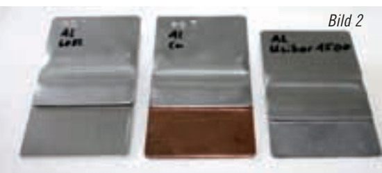
Empt Blechschweißen von Mischverbindungen
